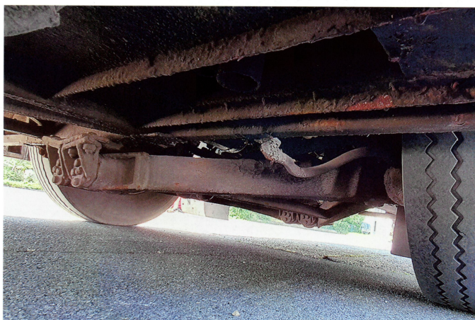
Dass der Hinterwagen dem Vorderwagen exakt folgt, dafür ist die letzte Achse zuständig, die in Abhängigkeit vom Knickwinkel des Gelenks eingeschlagen wird und so den Hinterwagen bei Kurvenfahrten entsprechend beweglich macht.
