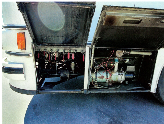
Direkt unter dem Fahrerfenster befindet sich der Elektrokasten. Dass eine so einfache Ausführung auch heute immer noch funktioniert, kann man sich bei der heutigen Technik kaum vorstellen.
