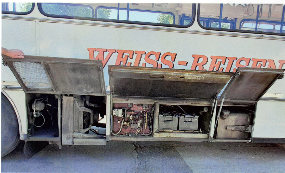
Zwischen Vorder- und Mittelachse befinden sich von links nach rechts ein Druckluftkessel, der Kühler, der zweite Elektrokasten, die Batterien und der Dieseltank.
