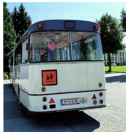
Für den Setra Gelenkbus üblich ist das Heck beidseitig etwas verjüngt, um bei Kurvenfahrten hinten nicht anzuecken.
